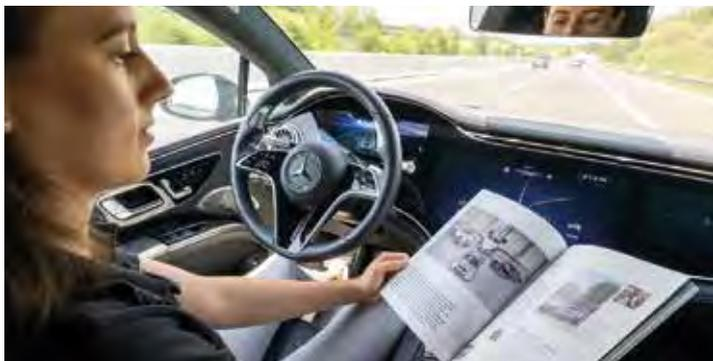
La marca de la estrella ha mejorado su sistema DRIVE PILOT para la conducción condicionalmente automatizada (SAE Nivel 3). Esta actualización ahora permite seguir a un vehículo en la autopista hasta 95 km/h, de momento solo en Alemania y cuando el sistema reciba la autorización de la Autoridad Federal de Transporte Motorizado de Alemania.
