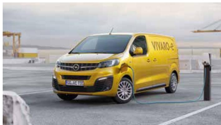
El Opel Vivaro-e es el primer vehículo comercial 100% eléctrico de la marca. Disponible en tres longitudes y con diversas variantes de carrocería, también permite elegir entre dos baterías de iones de litio, en función de sus necesidades: con 75kWh, con una autonomía de hasta 330 km; o de con 50 kWh y autonomía de hasta 230 kilómetros; ambos bajo el ciclo de prueba WLTP.
