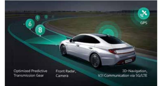
Hyundai Motor Company y Kia Motors Corporation han anunciado el desarrollo del sistema conectado de cambio (Connected Shift System). Se trata de la primera transmisión del mundo con control predictivo de cambio mediante conexión con tecnologías de la información y comunicación. Esto permite al vehículo cambiar automáticamente a la marcha óptima tras identificar las condiciones de la carretera y del tráfico. Hyundai y Kia planean aplicar esta tecnología en sus futuros vehículos.
