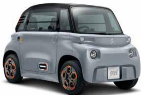
El fabricante galo siempre ha destacado por sus propuestas originales. Vehículos como el 2CV, el Mehari o más recientemente el Cactus son muestra de ello. Ahora Citroën rompe esquemas con el AMI, un minicoche de solo 2,40 metros de longitud, biplaza, 485 kg de peso y motor eléctrico con el que recorrer hasta 70 km. Además, al no superar los 45 km/h puede conducirse sin carné de coche.
